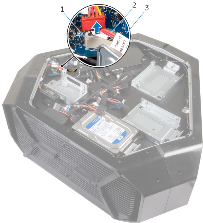
图 17: 卸下左侧 AlienFX 连接器
