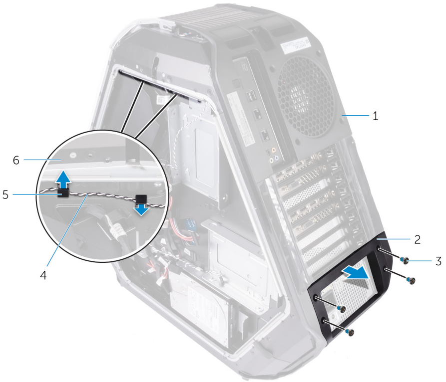
图 68: 卸下后部 I/O 入口照明电缆
